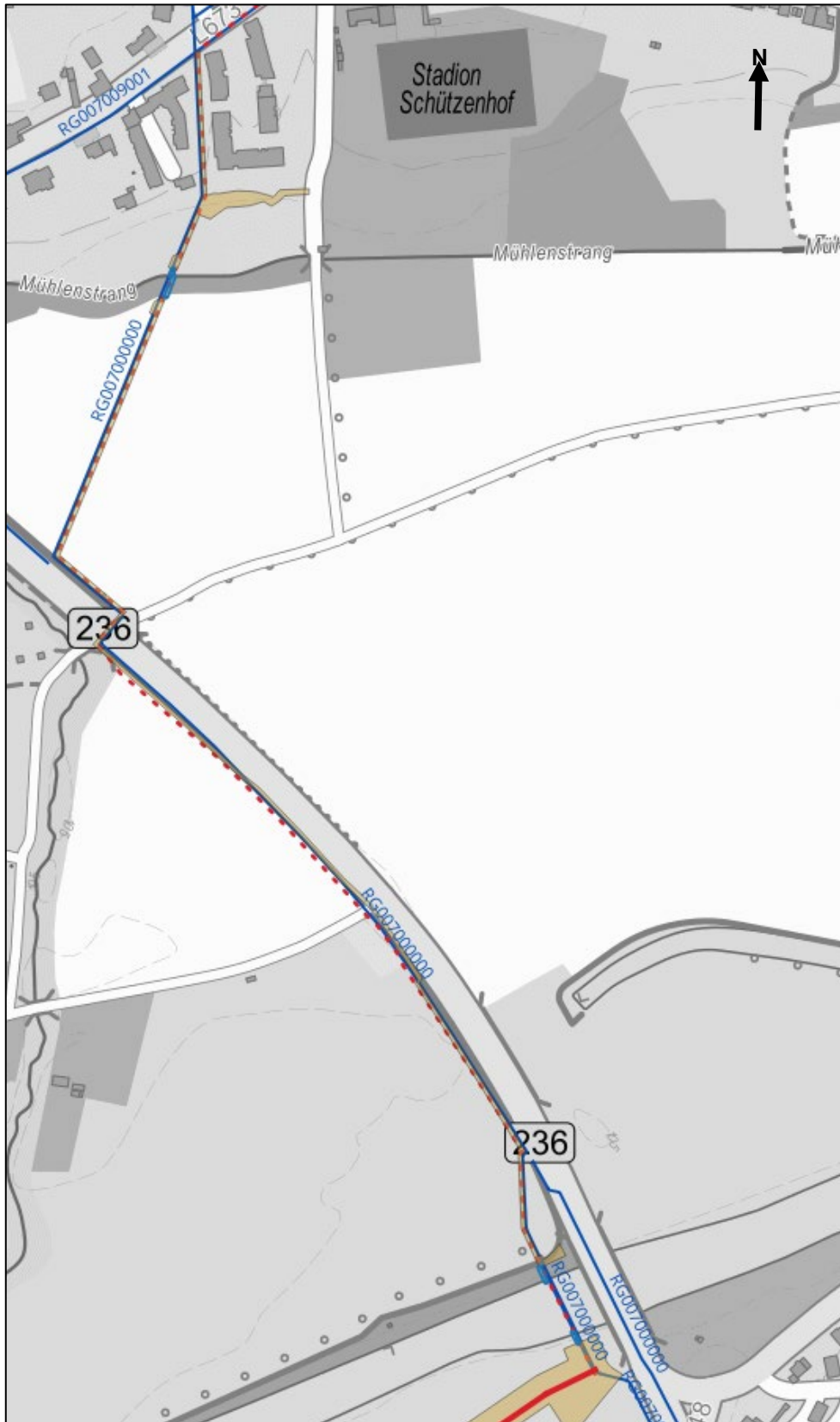
Abbildung 40: Verlegung in Parallellage zur LNr. 7
