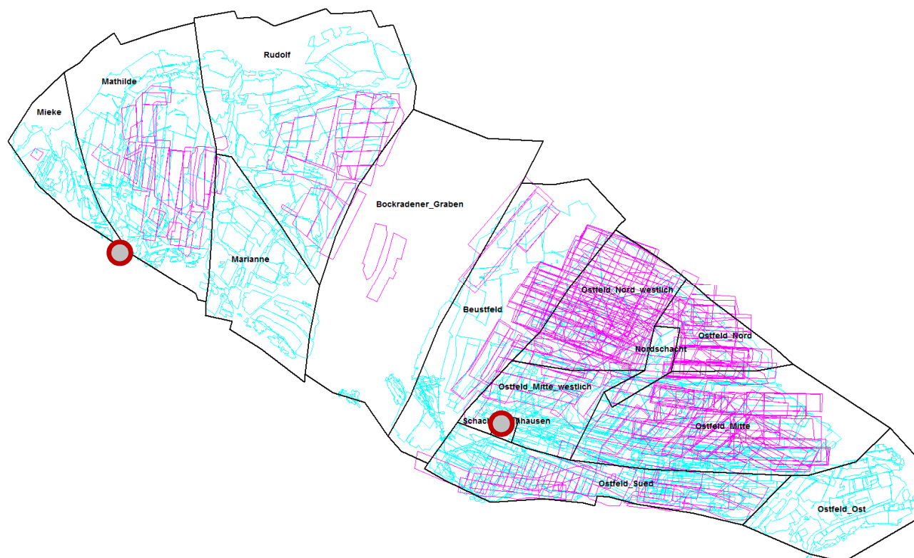
Abbildung 29: Boxmodell mit den digitalisierten Abbauflächen (ältere/höhere Abbaue Blau, jüngere/tiefere Abbau Magenta) und Wasserannahmestandorten.
